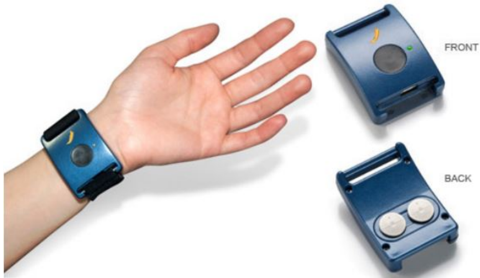
Figura 1: Dispositivo de captação de atividade eletrodérmica (pulseira Affective Q Sensor) [45].
