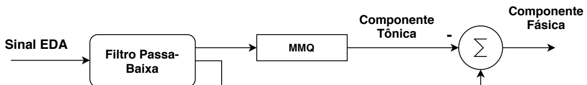
Figura 5: Diagrama de blocos do processo de separação do sinal de EDA em suas componentes fásica e tônica.
