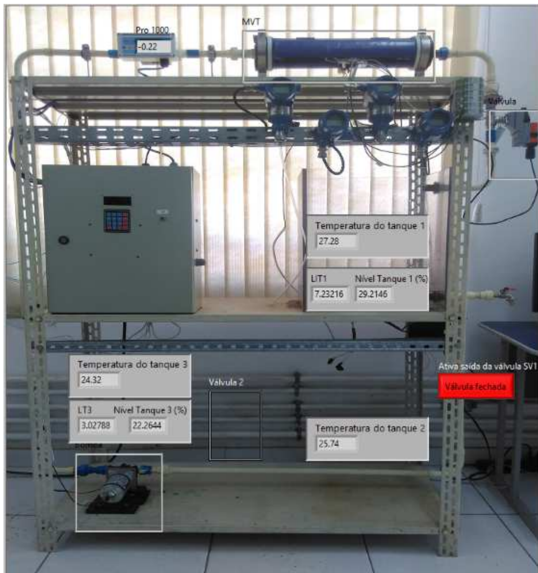
Figura 43 –Supervisor Labview – tela de comando
