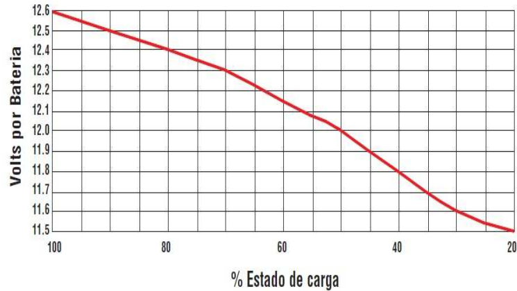
Figura 50: - Tensão terminal x Estado de carga [64]
