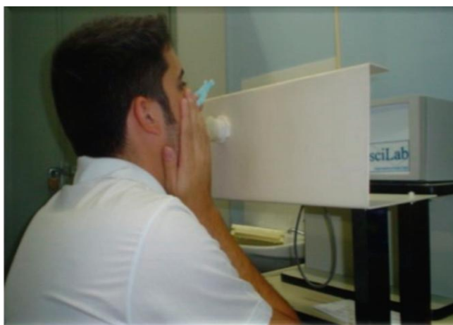
Figura 3 – Indivíduo realizando ensaios pela técnica de oscilações forçadas (MELO et al., 2015)
