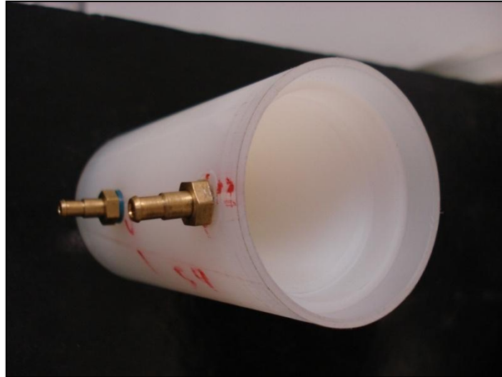
Figura 35 - Detalhe das conexões do tubo Venturi
