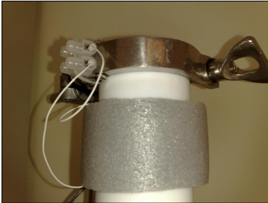
Figura 30 - Montagem Final do Sensor Termal com isolamento térmica
