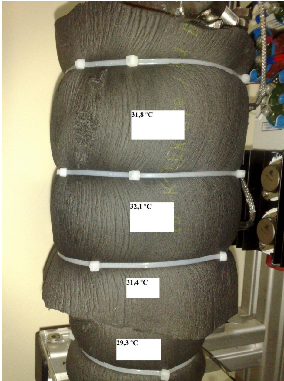
Figura 43 - Temperatura externa das luvas de Celeron com isolamento de Neoprene
