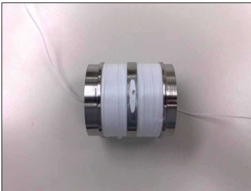
Figura 25 - Isolamento do Sensor Termal (ativo)
