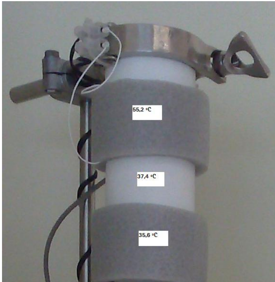
Figura 41 - Temperatura externa das luvas de Teflon
