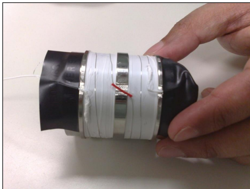
Figura 24 - Resistência de aquecimento do sensor termal (ativo)
