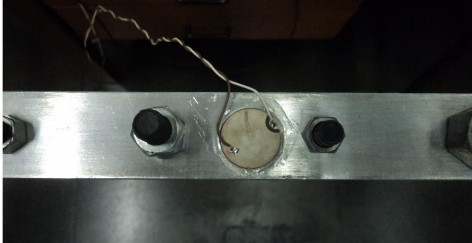
Figura 23 – Barra de alumínio com o sensor piezoelétrico.
