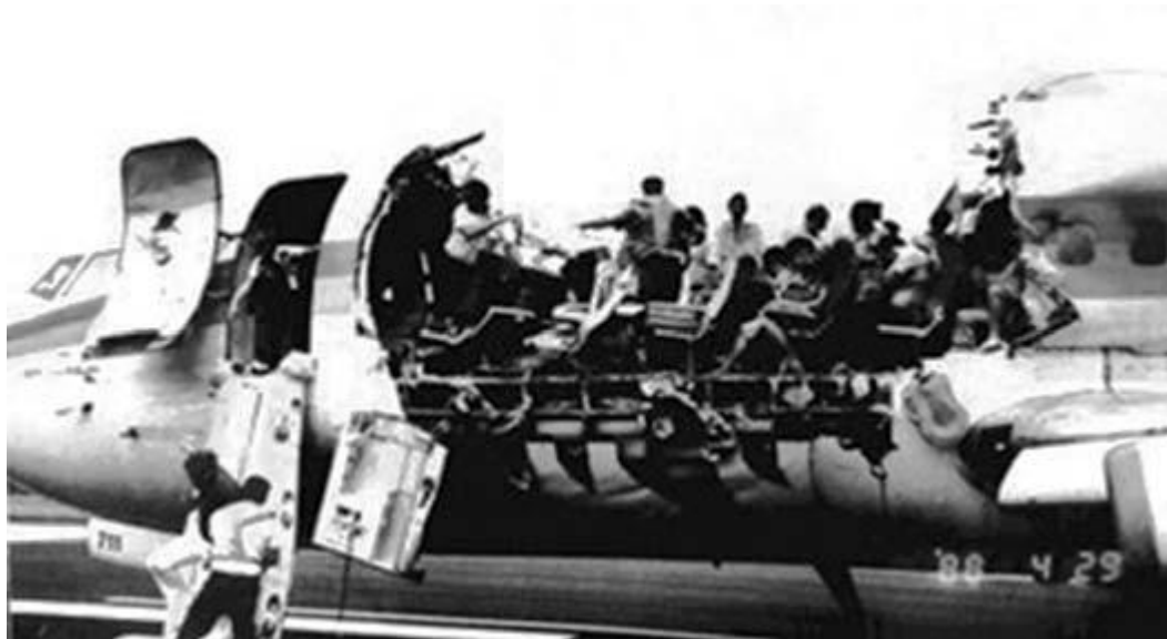
Figura 1– Perda de parte da fuselagem do avião da Aloha Airline em 1988.
