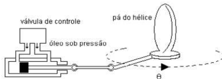
Figura 44 - Representação esquemática do atuador de passo (EPUSP, 2006).
