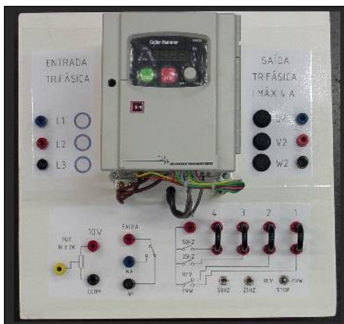
Figura 32 - Conversor de Frequência
