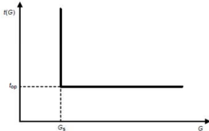
Figura 1 – Curva de proteção de sobrecorrente com característica de tempo independente.
