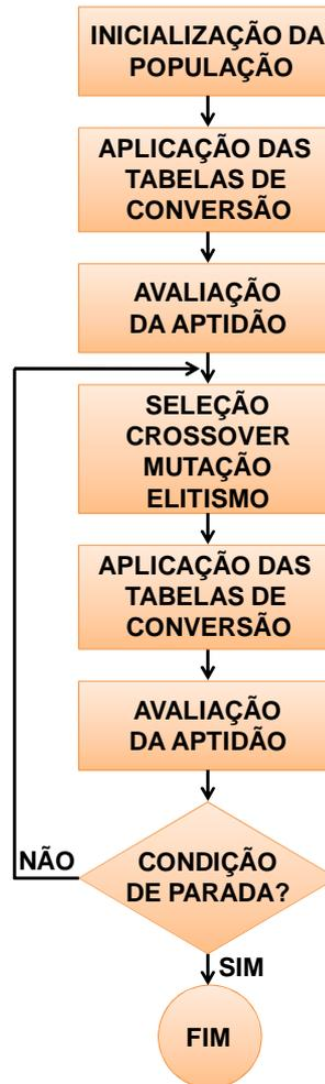
Figura 33– Fluxograma do algoritmo genético implementado.
