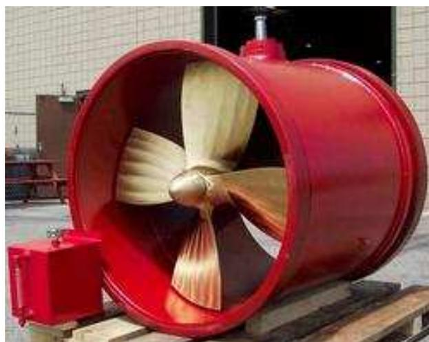
Figura 25 – Propulsor em túnel BT-400
