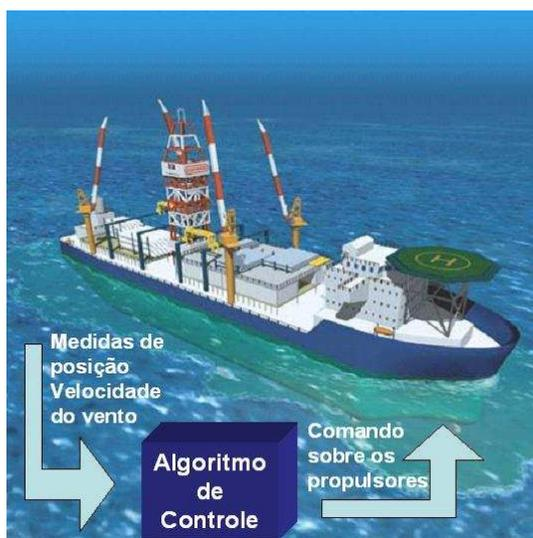
Figura 1 - Visão Geral do SPD de uma embarcação
