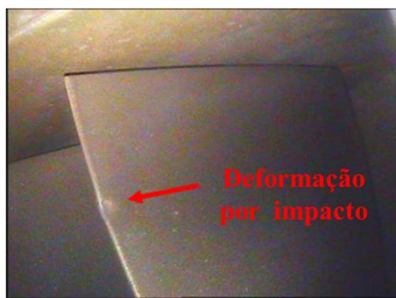
**Figura 3 – Palheta com dano por conta do impacto de um objeto estranho adaptado de (SOBRINHO, 2013)**
