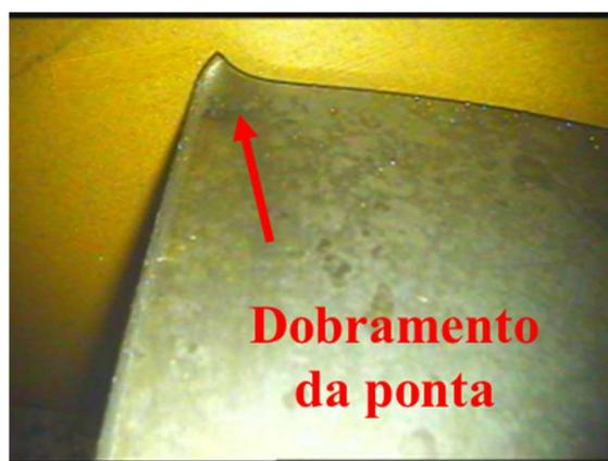
**Figura 2 - Dobramento da ponta da palheta devido ao atrito contra a carcaça da máquina adaptado de (SOBRINHO, 2013)**
